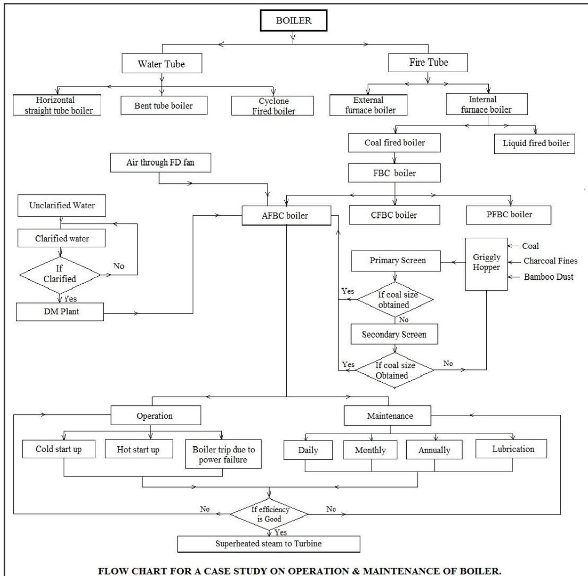
FLOW CHART FOR A CASE STUDY ON OPERATION & MAINTENANCE OF BOILER.
