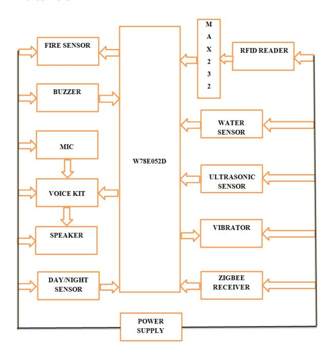
Figure 1: BLOCK DIAGRAM OF BLIND NAVIGATION SYSTEM
